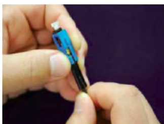
8. Syötä kuitu sisään varovasti, kunnes siihen muodostuu mutka.
