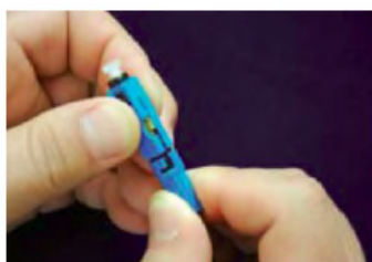
10. Aseta tyvisuojaus ja liitin kohdakkain. Lukitse kääntämällä oikealle
