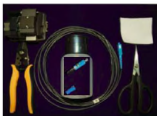
1. Ota liitin, kaapeli ja asennustyökalut valmiiksi
